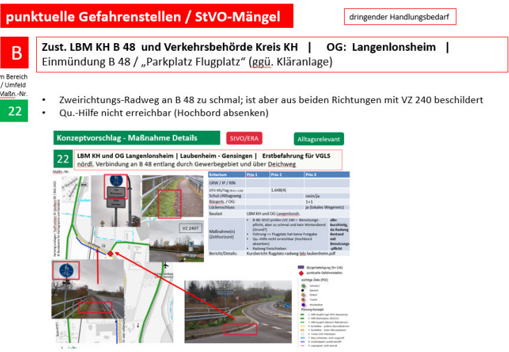
Abbildung 17: Beispiel für eine punktueller Gefahrenstelle, hier „B“; zugleich Maßnahmen Nr. 22 als Streckenabschnitt
