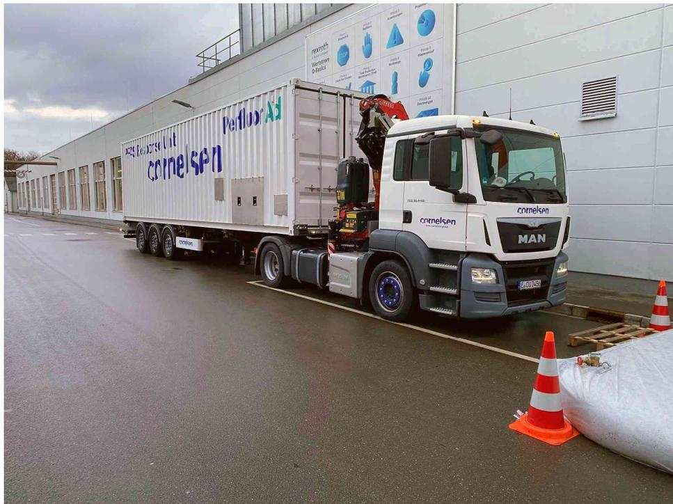
**Abbildung 3: Mobiler PerfluorAd®-Reaktor für die Behandlung von PFAS-belasteten Wasch- u./od. Feuerlöschwässern mittels PerfluorAd®**
