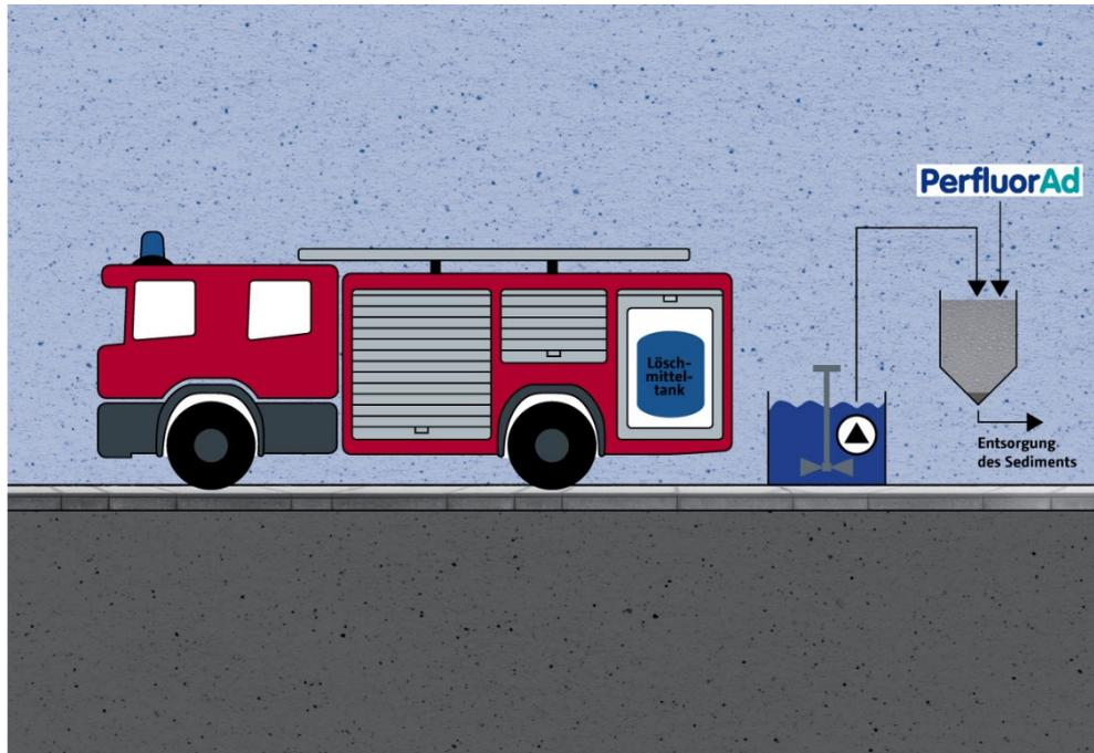
**Abbildung 2: Schematische Darstellung des Behandlungsprozesses des Waschwassers mittels PerfluorAd®**
